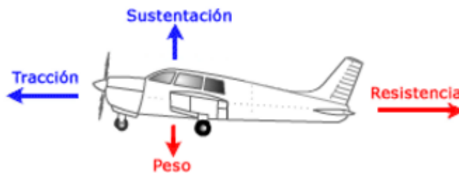
Ilustración 2-4 Fuerzas que actúan sobre una aeronave
