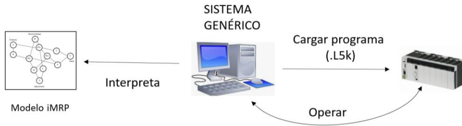
Figura 4.4 Descripción grafica de la solución propuesta utilizando el acoplamiento débil.
