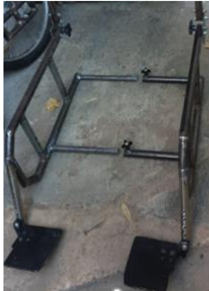
Figura 6.7 Prototipo del mecanismo telescópico desmontado.
