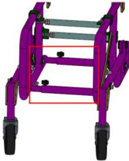
Figura 4.3 Mecanismo de plegado telescópico
