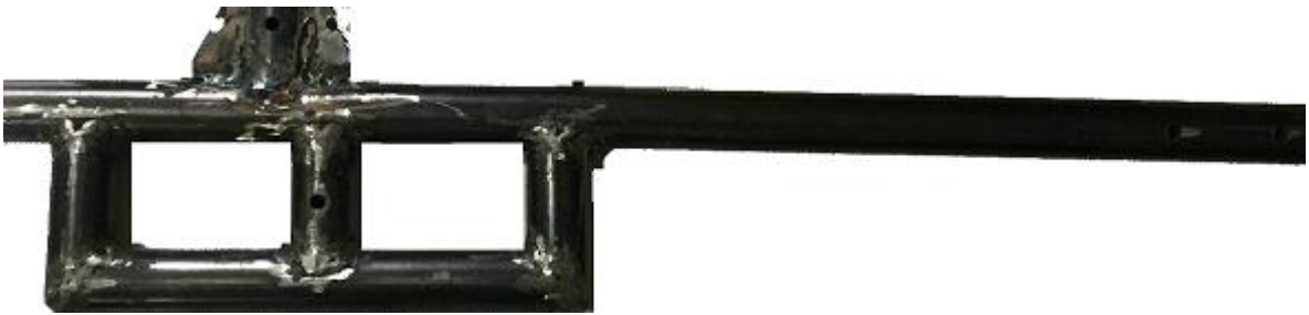
Figura 6.2 Prototipo de la estructura rígida de la silla de ruedas.
