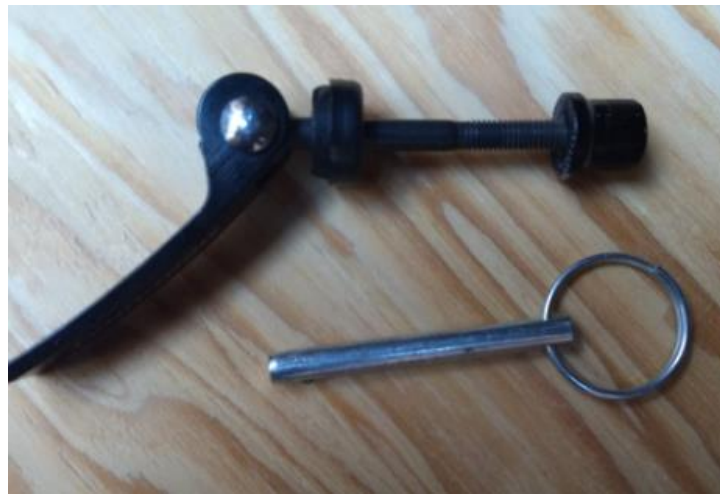
Figura 6.8 Tornillo con leva y perno de tirón.
