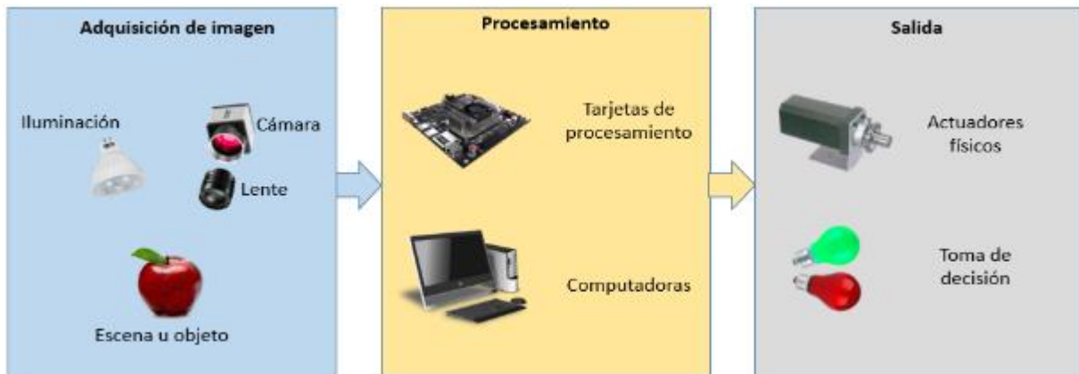
Figura 2.2 – Esquema de un sistema de visión típico.
