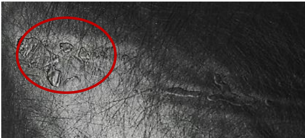
Figura 3.4 – Ejemplo de defecto de rasgado.
