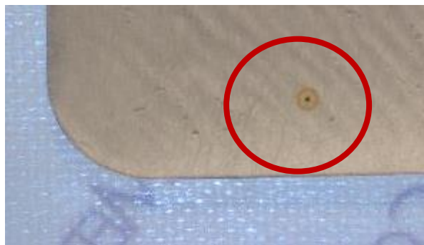
Figura 3.7 – Ejemplo de defecto de contaminación.
