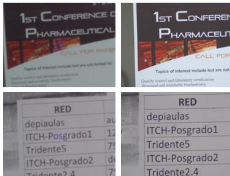
Figura 4.4 – Izquierda, imágenes obtenidas con la lente #54-689. Derecha, imágenes obtenidas con la lente M12B3525M12.
