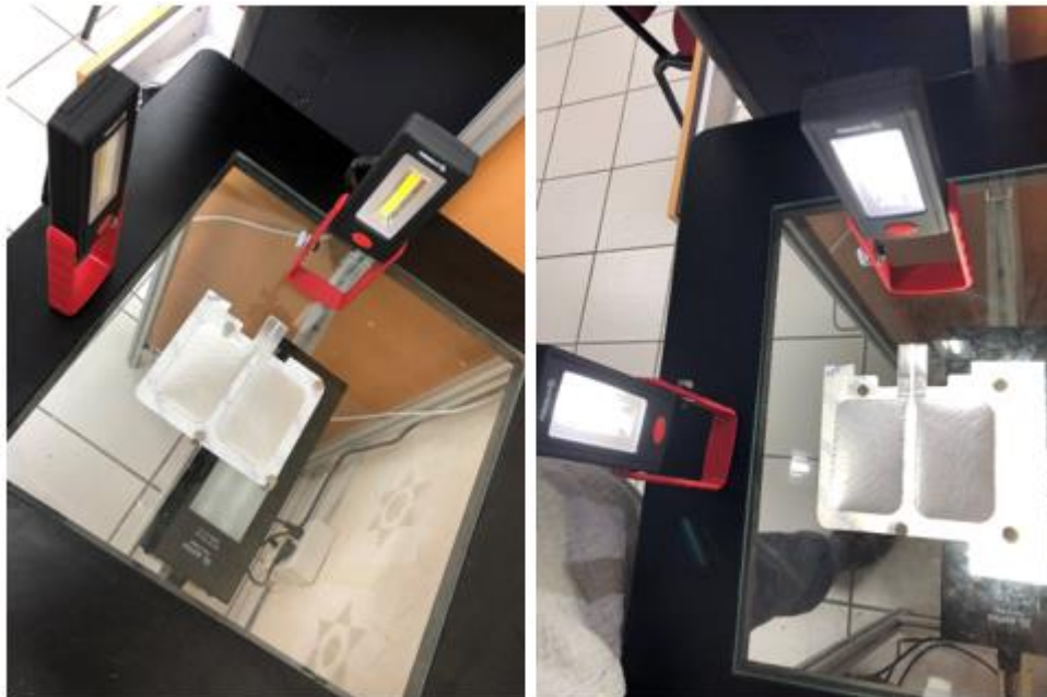
Figura 4.10 – Iluminación de campo oscuro, dos fuentes de luz perpendiculares a 10 cm y utilizando luz de fondo.
