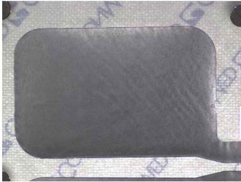
Figura 4.12 – Imagen capturada utilizando Iluminación de campo oscuro, dos fuentes de luz perpendiculares a 10 cm y utilizando luz de fondo.
