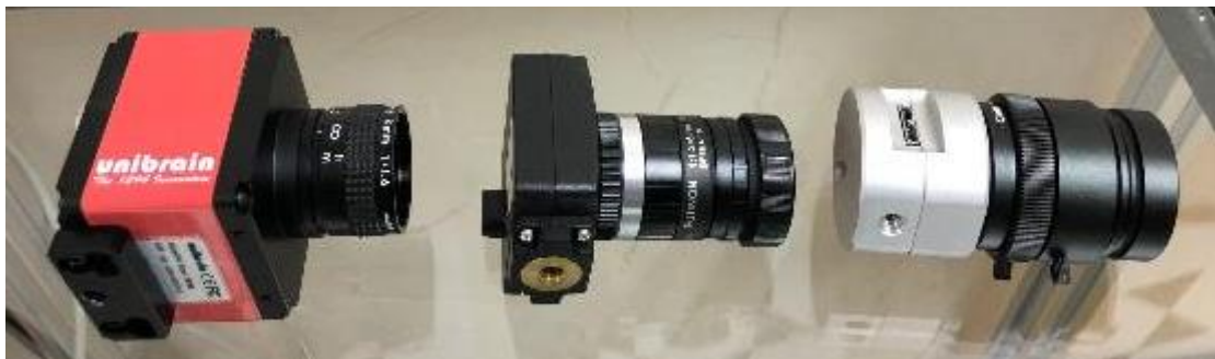
Figura 4.1 – De izquierda a derecha, cámara Unibrain Fire-i 785b, FLIR CMLN-13S2M-CS, Basler puA2500-14cm.
