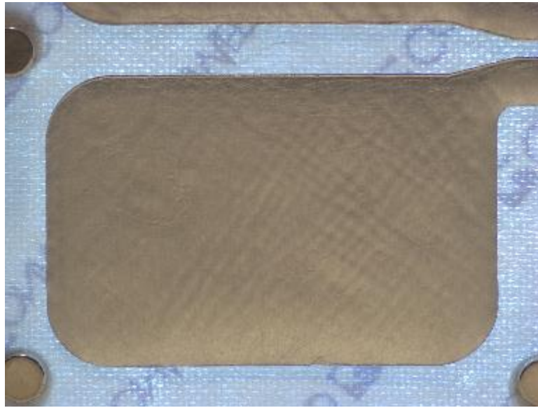
Figura 4.16 – Imagen capturada utilizando iluminación de campo oscuro con una sola fuente de luz a 80 cm y utilizando luz de fondo.
