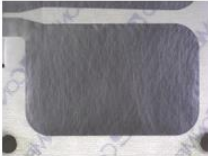
Figura 4.14 – Imagen capturada utilizando Iluminación de campo oscuro, dos fuentes de luz perpendiculares a 10 cm y utilizando luz de fondo.
