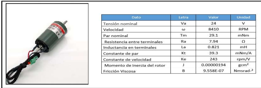
FIGURA 5.3: Parámetros del motor Maxon según especificaciones de fabricante.
