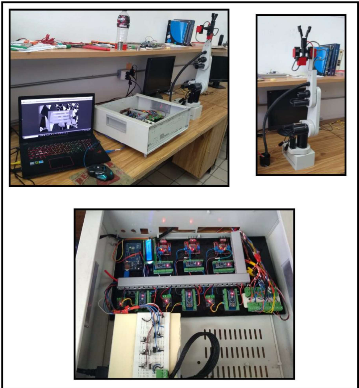
FIGURA 5.18: Resultados de la interconexión de la HMI, sistema de control y del brazo robótico
