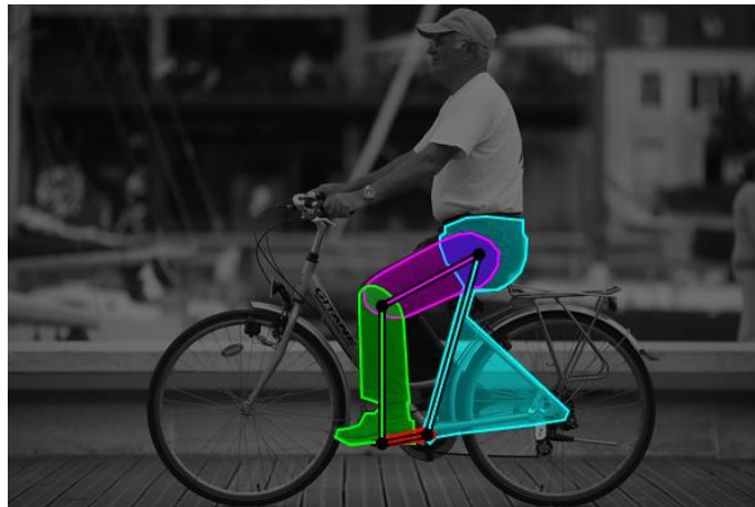
Figura 2.6: mecanismo de cuatro barras formado para propulsar una bicicleta [40]
