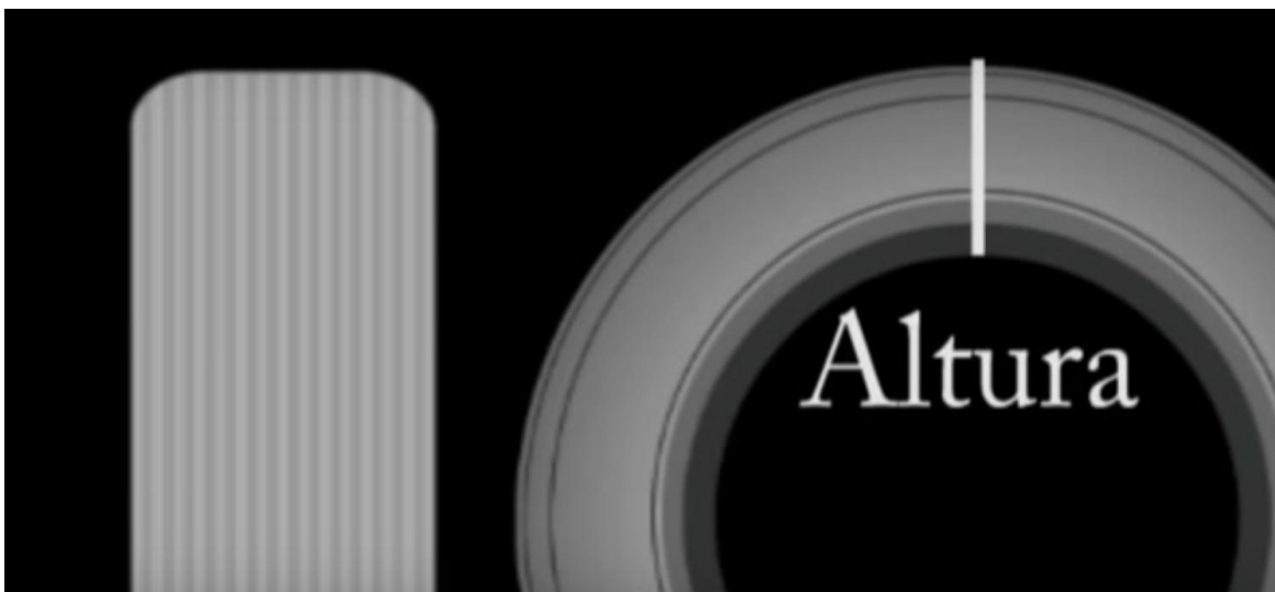
Figura 3.1: altura que se mide según la leyenda de los neumáticos comerciales.
