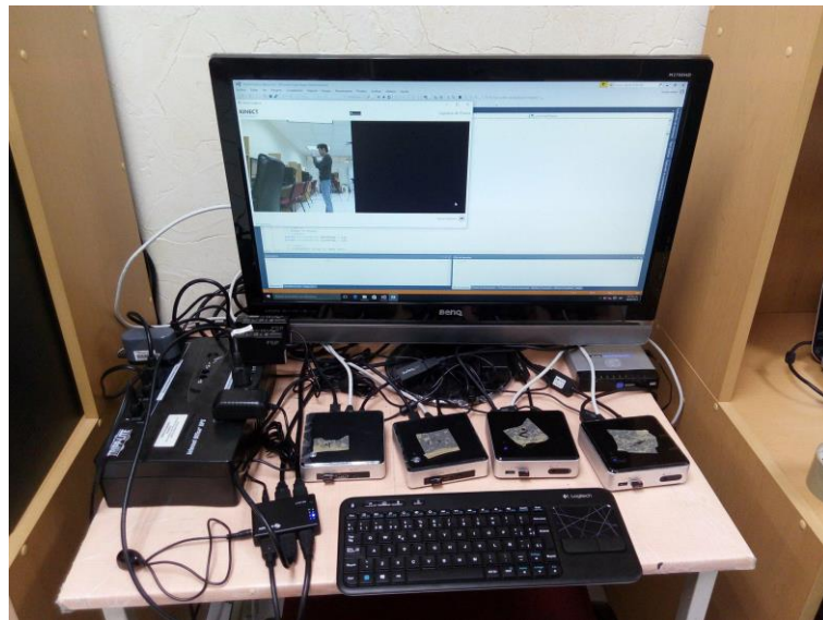
Figura 3.2. Conexión física de los cuatro Equipos de Captura.
