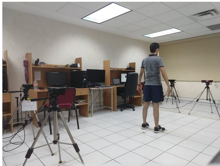
Figura 3.7. Escaneo de una persona en el área de captura tipo rectángulo.
