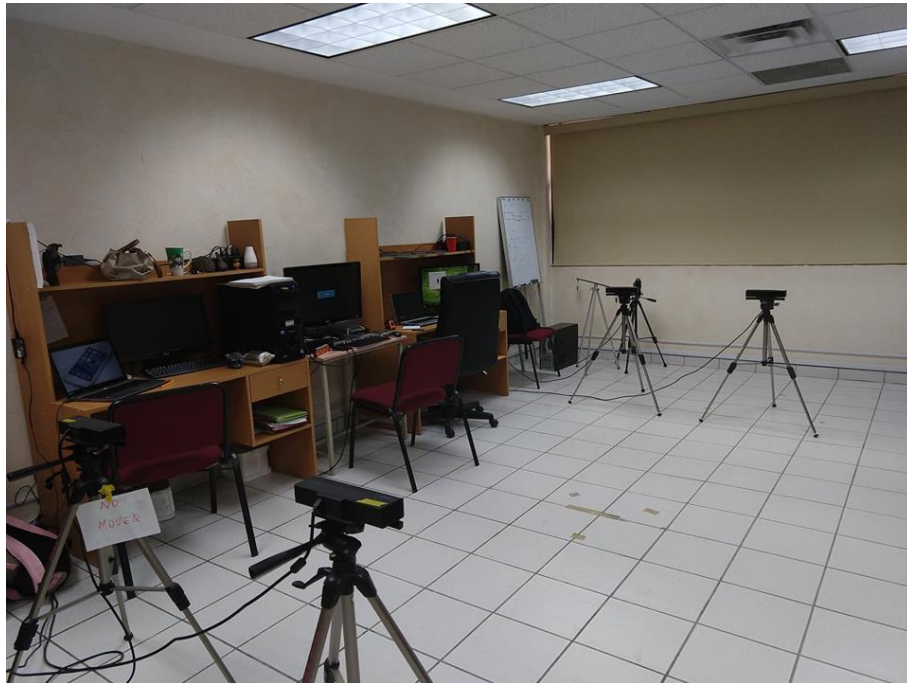
Figura 3.5. Implementación física del área de captura con geometría tipo rectángulo.
