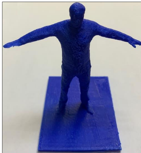
Figura 5.11. Pieza obtenida en la impresora Makerbot a partir del modelo tridimensional de una persona.
