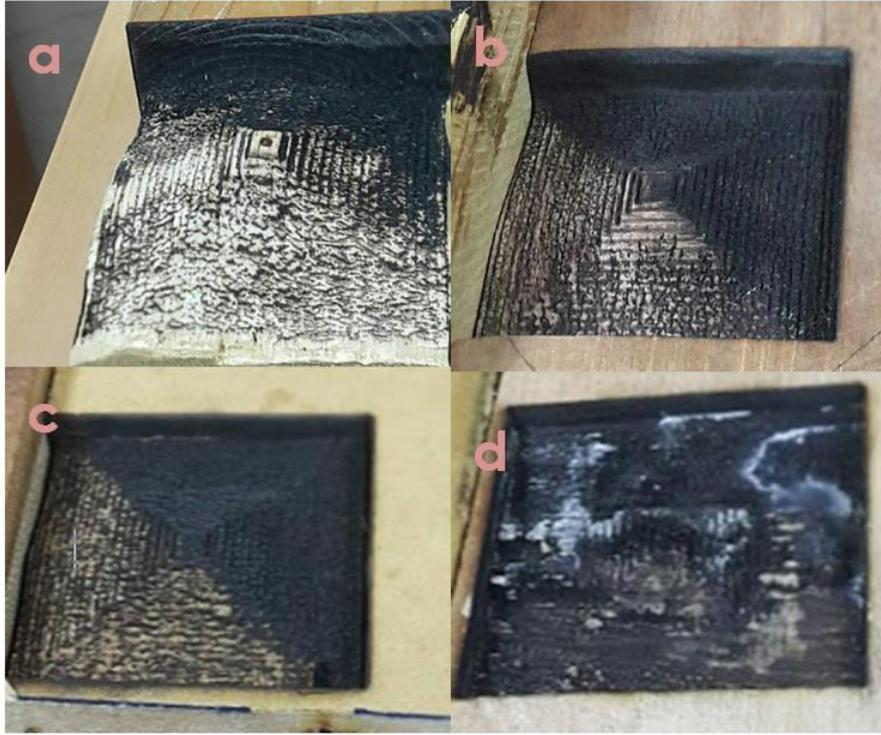
Figura V.4. Pirámide de 4 lados tallada en a) madera de pino, b) madera de nogal, c) MDF y d) triplay.
