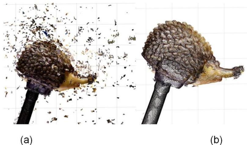
Figura II.9 Nube de puntos tridimensionales (a) con ruido y (b) filtrada.
