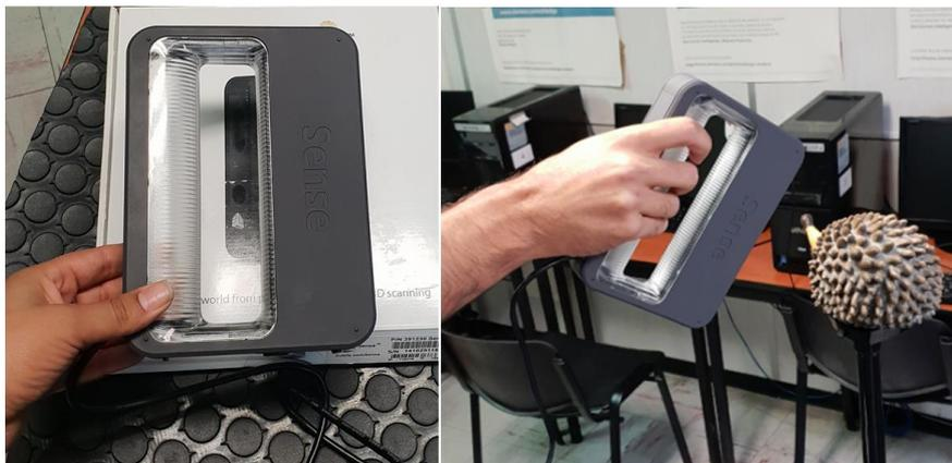
Figura III.3 Escáner 3D Sense 1 usado para la digitalización de las piezas.
