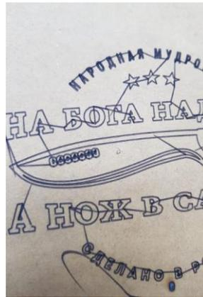
Figura V.1. Dibujo grabado en madera tipo MDF con el Código G de prueba.
