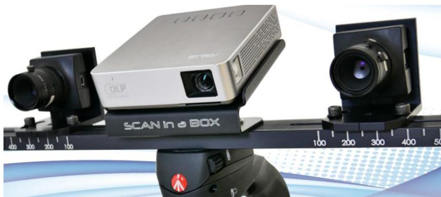
Figura II.5 Sistema de adquisición por medio de patrones de luz estructurada.
