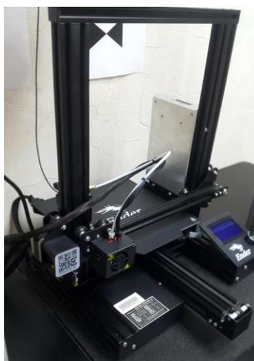
Figura IV.2. Ensamble final de la impresora Ender 3 Pro.
