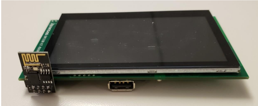
Figura 3.6 Interface entre modulo WIFI y tarjeta de desarrollo.
