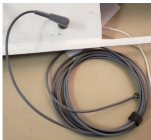
Figura 4.9 Sensor de temperatura de piel
