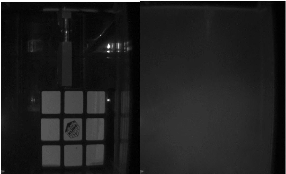
Figura 5.13. a) Imagen en un medio claro, b) Intensidad de la imagen en el medio altamente turbio.
