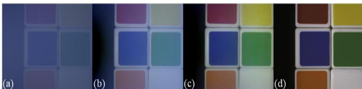
Figura 2.15 a) Imagen tomada en un medio turbio azul, b) Recuperación de la imagen sin la compensación, c) Recuperación de la imagen con la compensación, d) Imagen en un medio no turbio [21].
