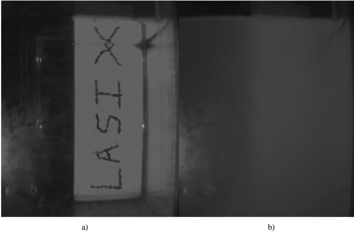
Figura 5.11. a) Imagen en un medio claro con el objeto 2, b) Intensidad de la imagen en el medio turbio.
