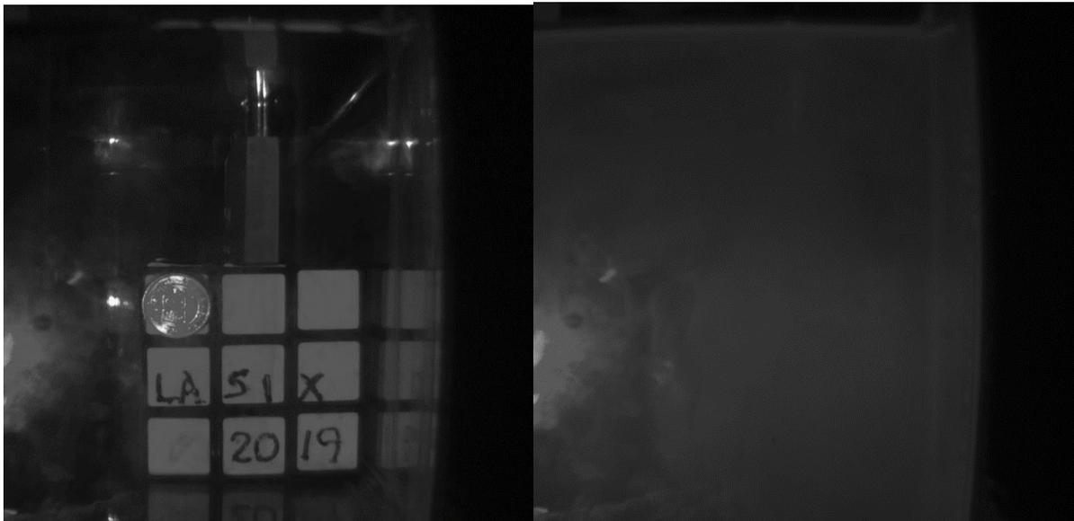
Figura 5.9. a) Imagen en un medio claro, b) Intensidad de la imagen en el medio turbio.
