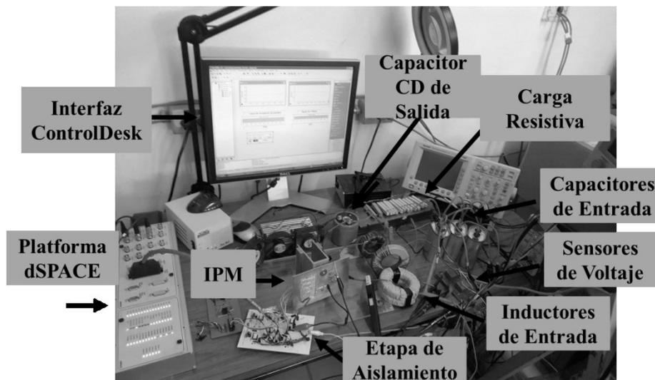
Fig. 5.1 Montaje experimental utilizado para la implementación del rectificador trifásico.
