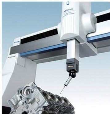
Figura 2.2 Sistema de posicionamiento tridimensional explorando un motor de combustión interna.
