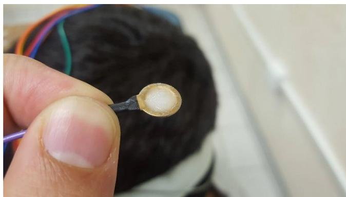
Figura 2.11 Electrodo de copa con el gel conductor.
