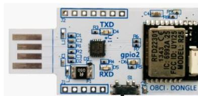
Figura 2.4 Dispositivo USB para la conexión bluetooth con OpenBCI<sup>®</sup> [10].
