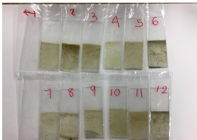
Figura 3.1. Muestras enumeradas de polianilina depositada en sustratos de vidrio.
