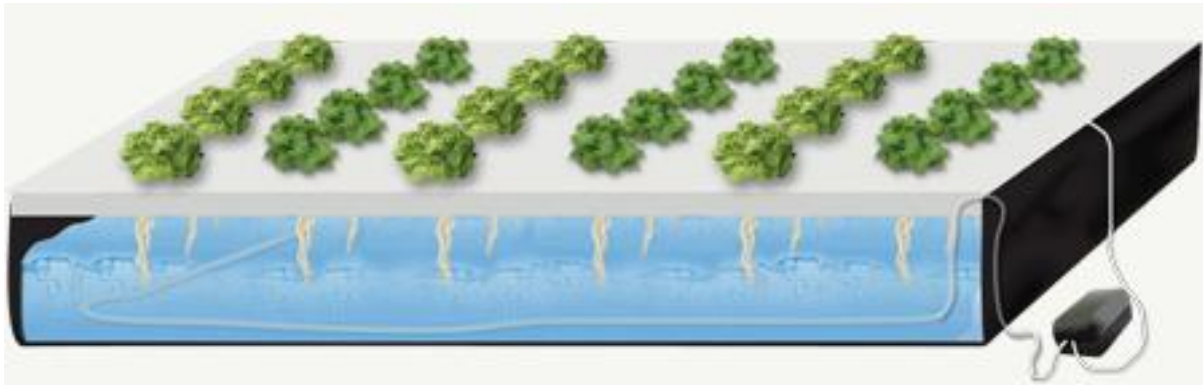
Figura 3.1. Diagrama de sistema de hidroponía de raíz flotante.
