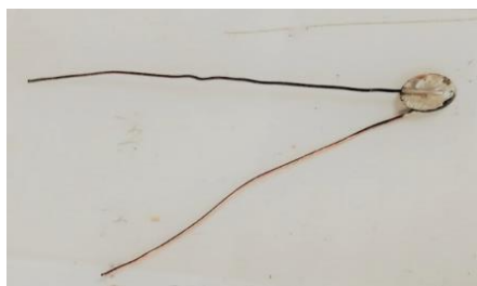
Figura 3.4. Sensor de polianilina en forma de pastilla con terminales de cobre.
