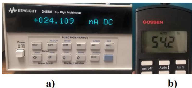
Figura 3.6 Ejemplo de medición con diferentes instrumentos. a) Sensor cuántico. b) Luxómetro.
