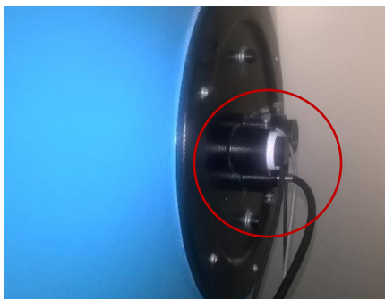
Figura 3.5 Sensores insertados en los puertos de la esfera integradora.
