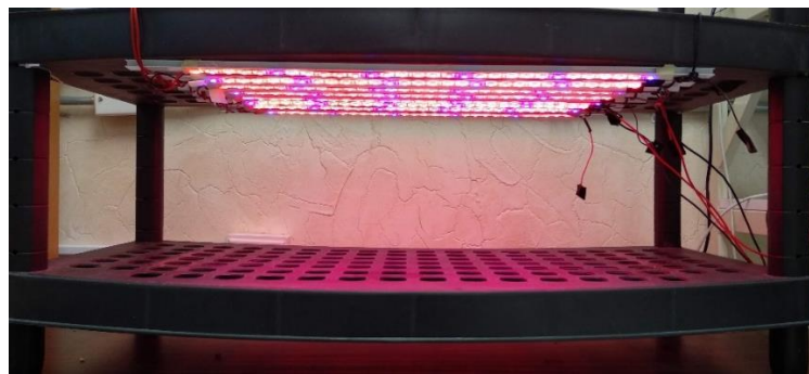
Figura 4.17 Estructura para germinación de plantas con iluminación tipo led.
