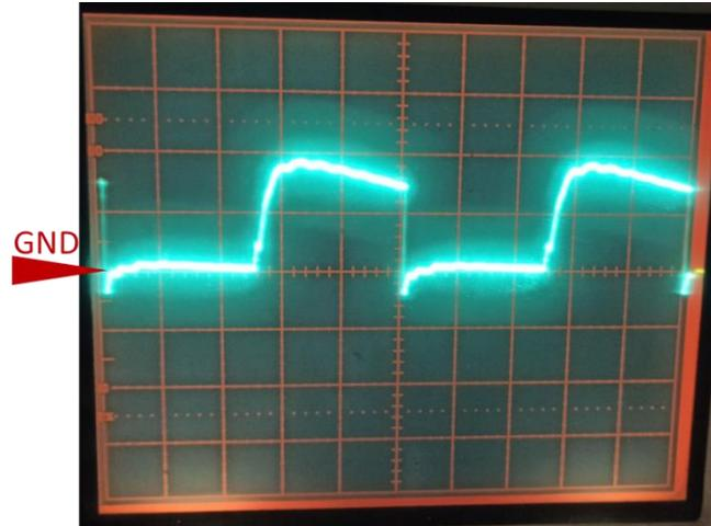
Fig. 5.19 Forma de onda de la señal de tensión entre compuerta y fuente (*gate-source*) del transistor  $Q_{D0}$  obtenida en experimentación a una escala de  $2\text{ V/Div}$  y una base de tiempo de  $2\text{ }\mu\text{s/Div}$ .
