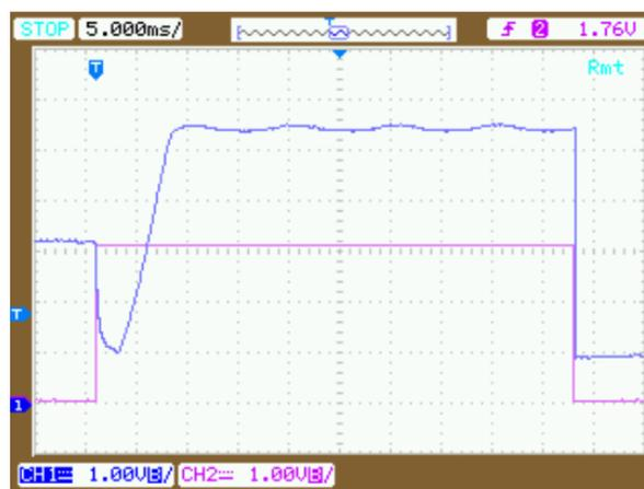
Fig. 2.14 Formas de onda experimentales del sistema en operación, en trazo azul, la señal de la terminal *HELD\_SAMPLE* siendo modificada acorde a la señal *PULSE* (trazo rosa) dada por el multivibrador astable.
