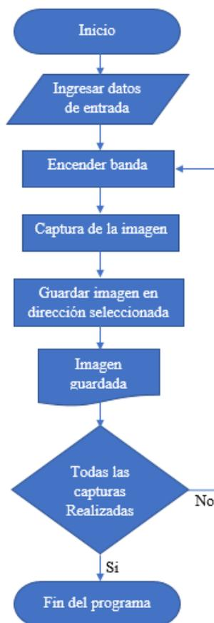
Figura 4.8 Diagrama a bloques de la secuencia de adquisición de imágenes.
